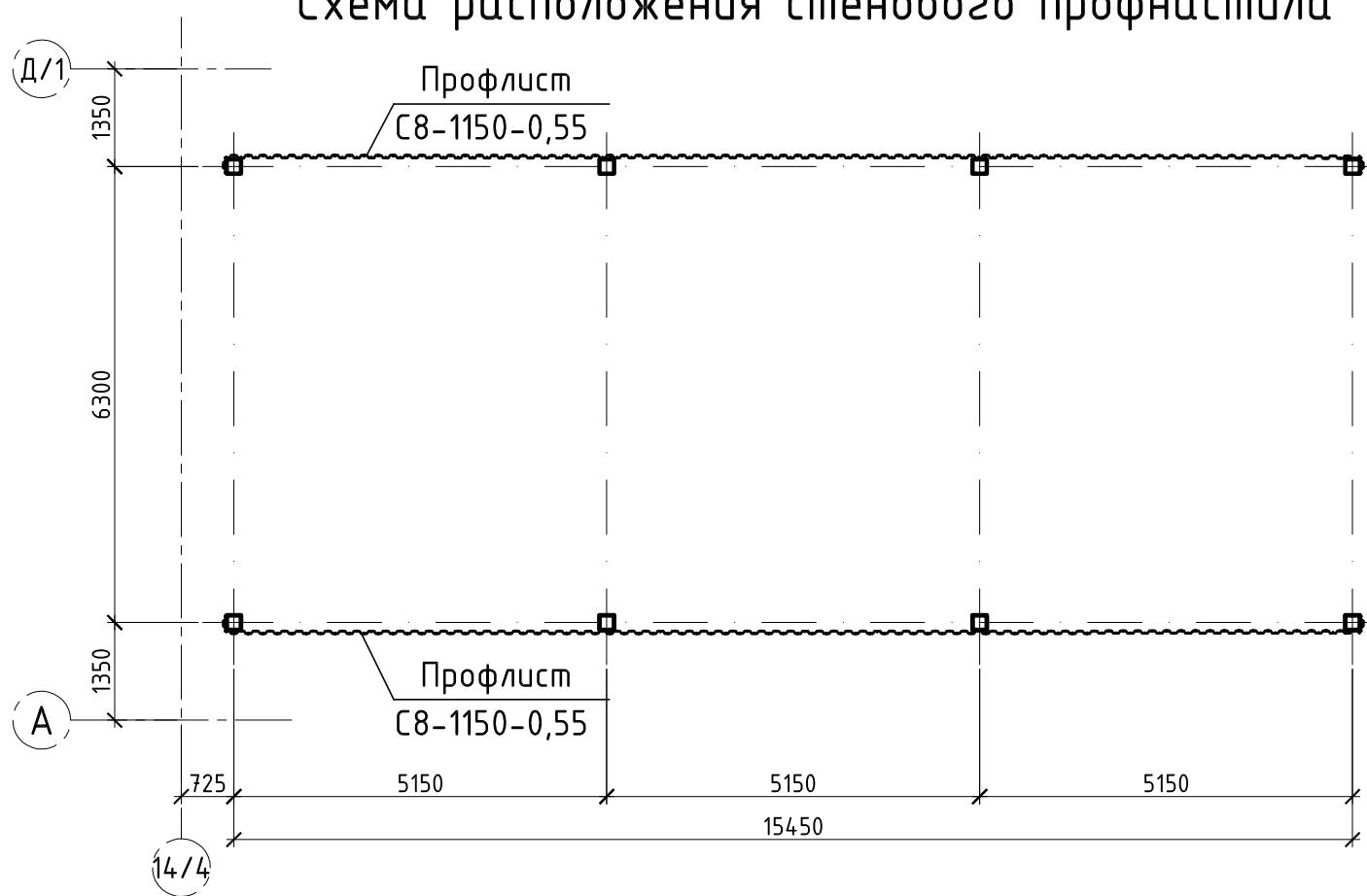
Схема расположения стенового профнастила
