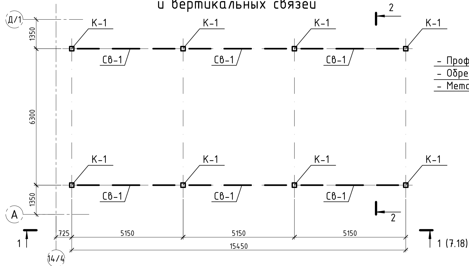
Схема расположения балок и горизонтальных связей
